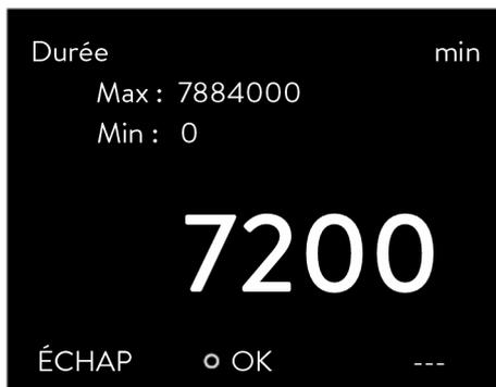
1. Sélectionner les options de menu *Programmeur*  $\rightarrow$  *Rampe*  $\rightarrow$  *Durée* et saisir la durée 7200 (min).
