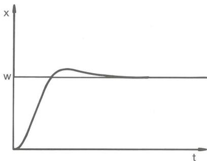
Fig. 66: Paramètre de contrôle  $X_p$  trop élevé
