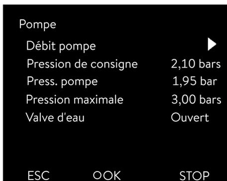
Fig. 29: Menu Pompe sur les appareils Integral IN XT
