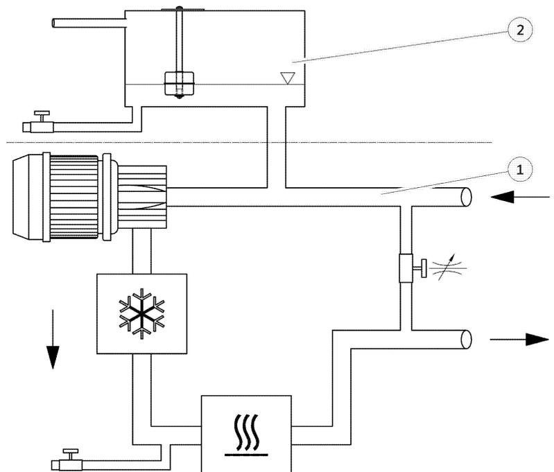
Fig. 6: Schéma du circuit hydraulique
