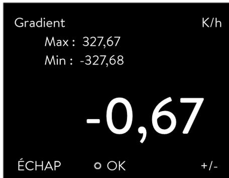
1. Sélectionner les options de menu *Programmeur*  $\rightarrow$  *Rampe*  $\rightarrow$  *Gradient* et saisir le gradient -0,67 (K/h).
